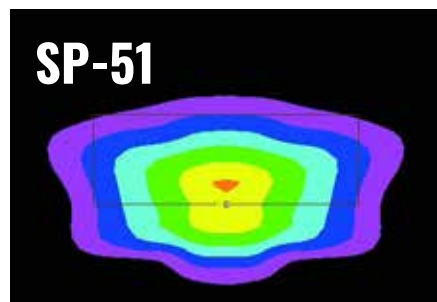
Optiikka, joka antaa runsaasti takavaloa. Pitkälle pylväsvälille. Erittäin energiatehokas, jos kevyen liikenteen väylä on sijoitettu pylvään taakse.
